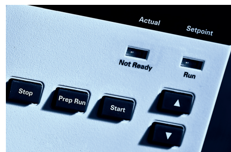
Простая клавиатура из пяти клавиш минимизирует вероятность ошибки оператора.
